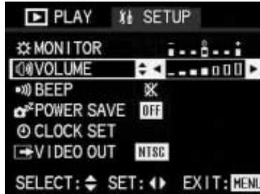
5. Wählen Sie durch Drücken des linken oder rechten Randes der 4-Wege Wippe die gewünschte Lautstärke. Es stehen 6 Stufen zur Verfügung, die Höhe der Balken repräsentiert die Lautstärke. Die Einstellung wird durch die gelbe Kennzeichnung der Balken angezeigt.
