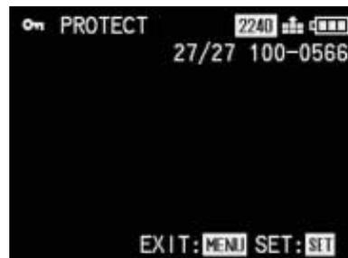
6. Drücken Sie zum Schützen der Aufnahme die **VIEW/SET**-Taste. Die Anzeige im Monitor wechselt, oben links erscheint jetzt **UNPROTECT**, darunter das Symbol für eine geschützte Aufnahme **PROTECT**.
