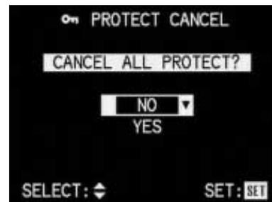
7. Wählen Sie durch Drücken des oberen oder unteren Randes der 4-Wege Wippe **NO** zum Erhalten, oder **YES** (mit nach oben zeigendem Pfeil und gelb gekennzeichnet, wenn aktiviert) zum Löschen aller Schutz-Einstellungen.
