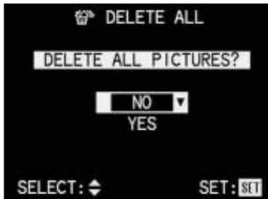
7. Wählen Sie durch Drücken des oberen oder unteren Randes der 4-Wege Wippe **NO** – zum Erhalten eines Bildes – oder **YES** – zum Löschen.
