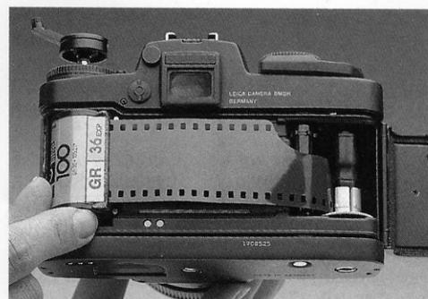
Dann die Filmpatrone in den leeren Filmpatronenraum einlegen. Dazu die Rückspulkurbel ganz hochziehen. Rückspulkurbel einschieben, wenn die Filmpatrone eingelegt ist. Die Filmkante muß parallel zur Filmführung liegen. Die Zähne der Transportwalze müssen beim Betätigen des Schnellschalthebels in die Perforationslöcher des Films eingreifen.
