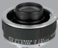
**LEICA APO-EXTENDER-R 1,4 x** Mit diesem handlichen Objektivzusatz verlängern Sie die Brennweite des angesetzten Objektivs um das 1,4fache. Die jeweils kürzeste Einstellentfernung bleibt dabei unverändert, die Lichtstärke verringert sich lediglich um eine Blende. Vollautomatische Springblendenübertragung. Wir informieren gern, mit welchen Objektiven der LEICA APO-EXTENDER-R 1,4 x kombiniert werden kann. **Bestell-Nr. 11 249**
