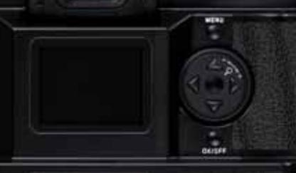
**Kreuztasten/Menu/OK/OFF** Diese Tasten dienen dem schnellen Navigieren in den übersichtlichen Menüs und zur Auswahl und Vergrößerung der gemachten Aufnahmen. Die Menüfunktionen auf dem Monitor dienen vorwiegend zur Basiskonfiguration des LEICA DIGITAL-MODUL-R (z. B. Nutzerprofil, Farbmanagement, Monitor-Helligkeit und -Kontrast).
