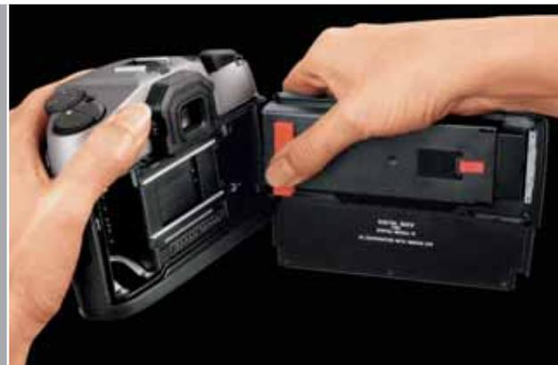
Nach Abnahme des Schutzdeckels liegt der Bildsensor frei und kann bei Bedarf gereinigt werden. Der Sensor ist federnd gelagert und positioniert sich so exakt in der Schärfenebene.
