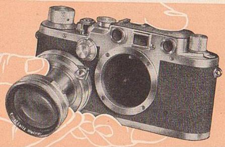
Bei ausgeschraubtem Objektiv ist der Schlitzverschluss sichtbar. Er besteht aus einem hitze- und kältebeständigen Spezial-Gummituch, dessen Geschmeidigkeit einen weichen, erschütterungsfreien Ablauf sichert. – Am oberen Rand der Kamerarückwand liegt der Übertragungshebel für die Kupplung von Objektiv-einstellung und Entfernungsmesser, der durch eine Übertragungskurve am Objektiv gesteuert wird.
