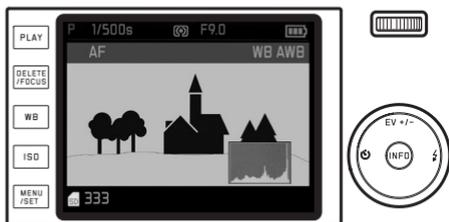
Diese Darstellungsform erlaubt – neben dem Bildeindruck selbst – eine zusätzliche, schnelle und einfache Beurteilung der Belichtungseinstellung.
