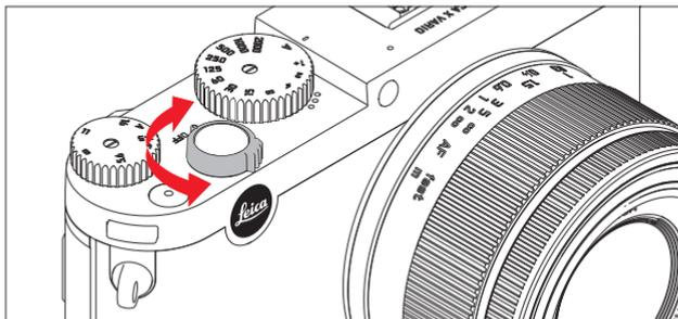
Die Leica X wird mit dem Hauptschalter ein- und ausgeschaltet:
